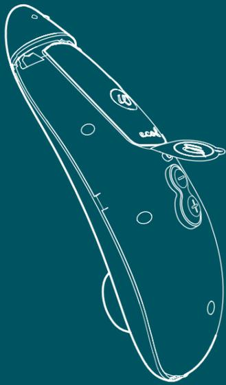
Verwende die Öffnungshilfe, um die Akkuabdeckung zu lösen
